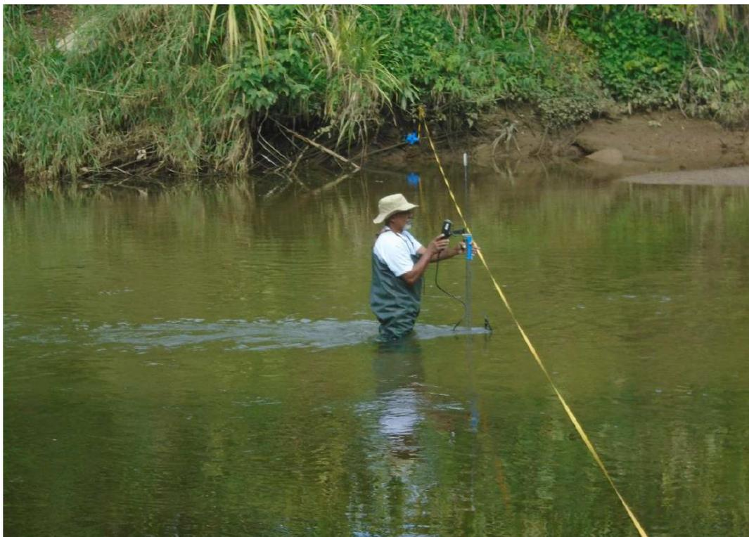
Figura 4.3 - Medição de vazão com Flowtracker no Rio Bracuí
